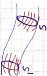
\* Più fitta sono le linee di corrente → maggiore è la velocità del fluido
